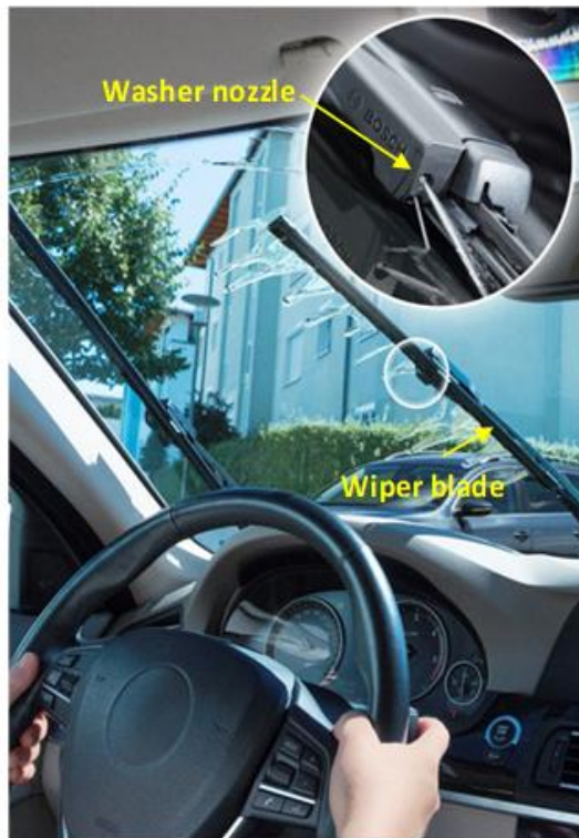
Fig. 29. Bosch Jet Wiper [23]
