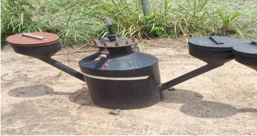
Figure 1:A 32L biodigester.
