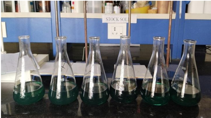
Fig 5. TOC titration endpoint green color
