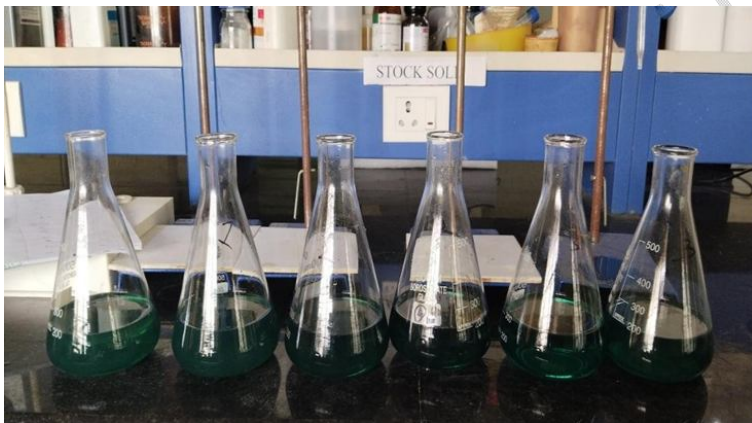
Fig5. TOC titration endpoint green color
