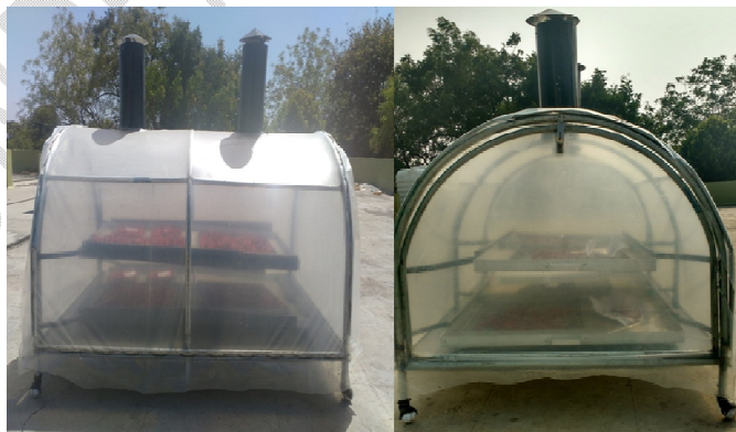
Figure1. Developed mini solar tunnel dryer
